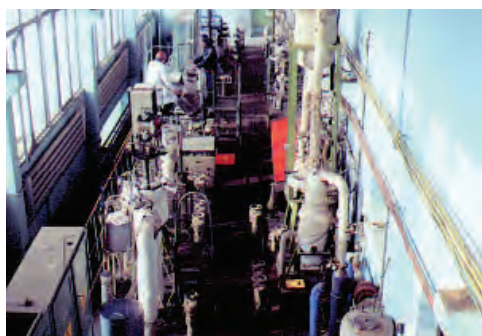
Стенд с жидким металлом для исследования динамики течений и температурных полей реакторов
