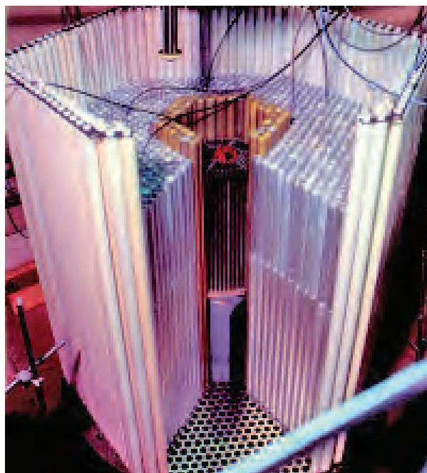
Критическая сборка для исследования реакторно-лазерных систем с ядерной накачкой
